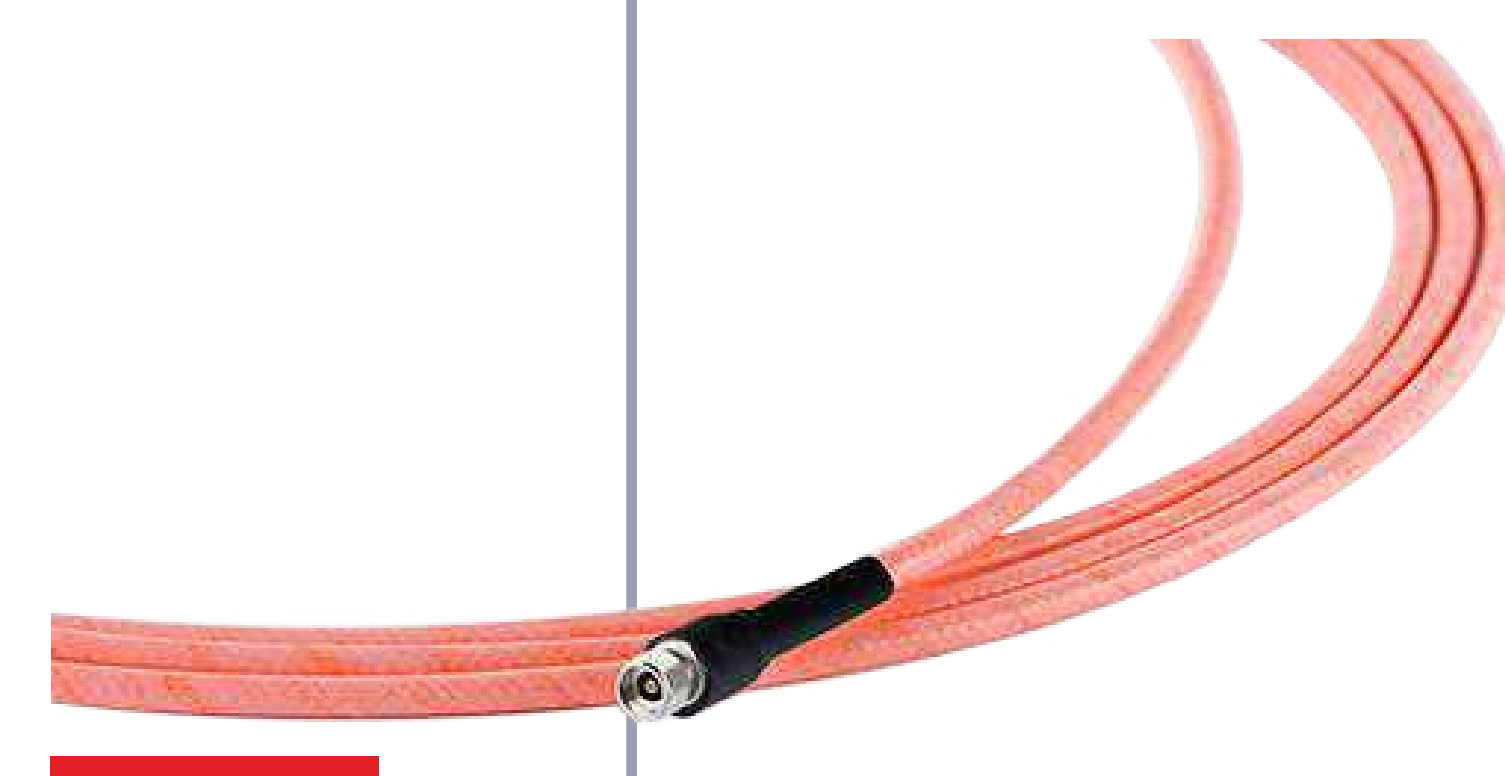
Фазостабильные кабели, с минимальными потерями, адаптированные под высокие температуры до 110 ГГц Температурный диапазон: -65 °C / ~ +200 °C
